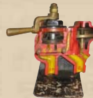
Spaccato del freno a 5 posizioni Westinghouse
